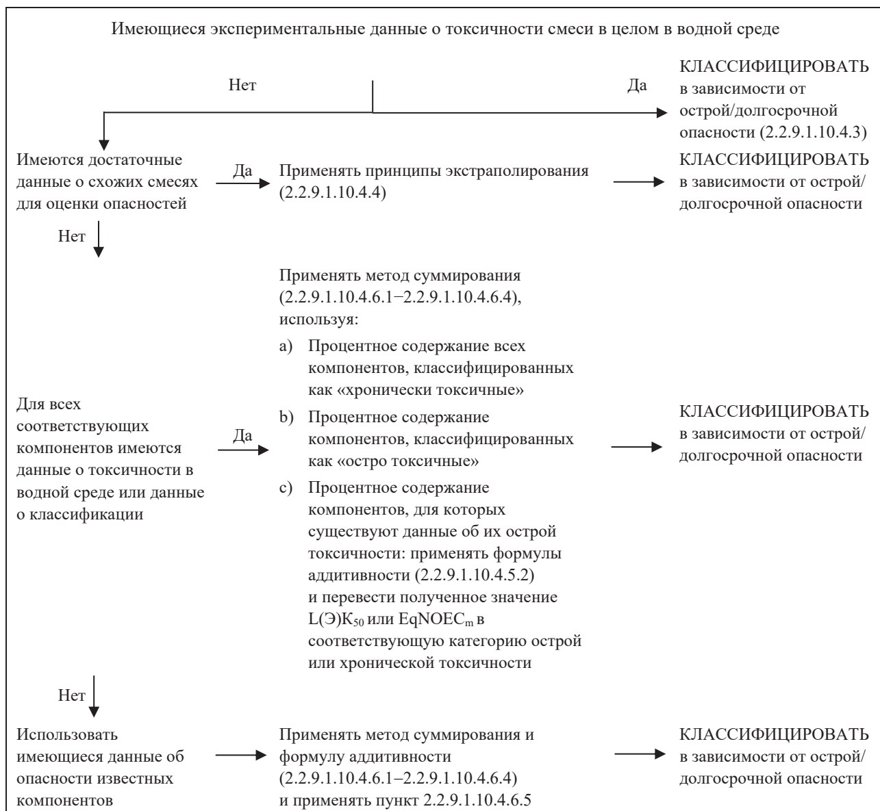
Рис. 2.2.9.1.10.4.2: Ярусный подход к классификации смесей в зависимости от их острой и долгосрочной опасности для водной среды
